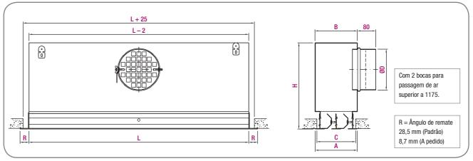
Possibilidade de fabricar um pleno por medida, em função da disponibilidade de altura em tecto falso.
