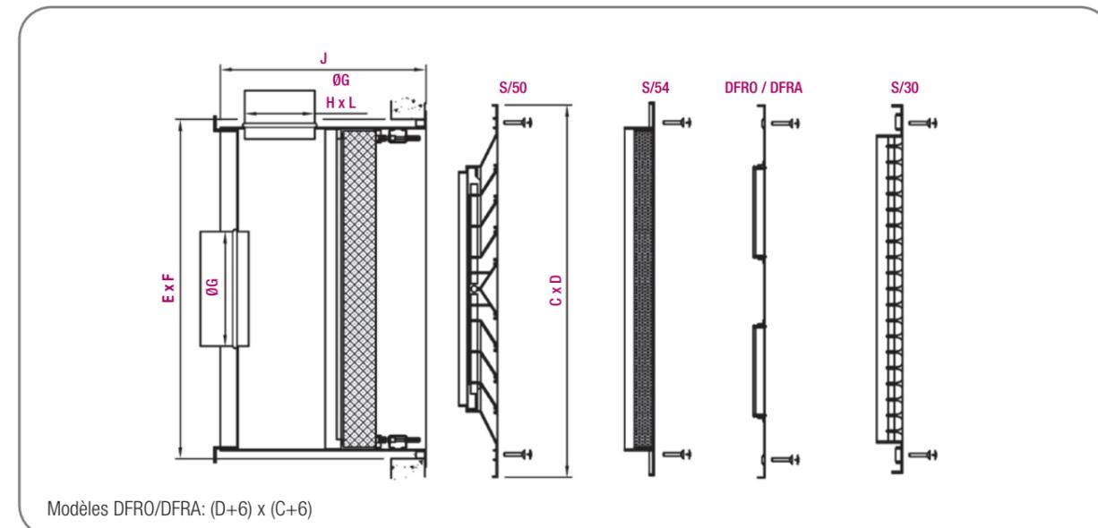
Possibilité de fabrication d'un plénum sur mesure en fonction de la hauteur disponible à l'intérieur du faux plafond et débit d'air par unité. Consulter le service technique.
